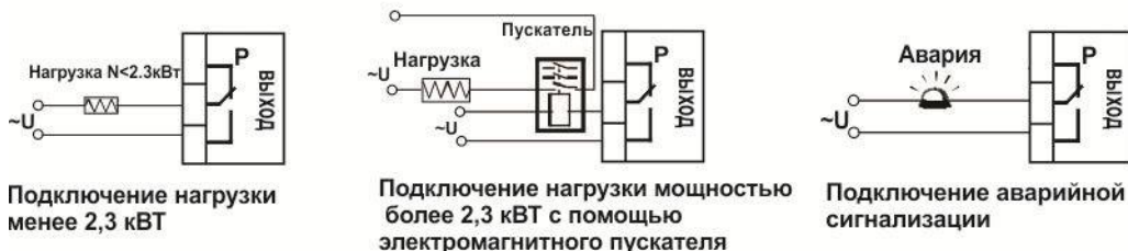
Рисунок 4 – Схемы подключения релейных выходов.
